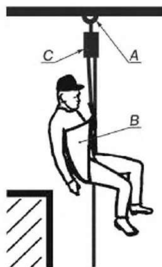
A — анкерная точка; B — устройство для поддержания тела (спасательная петля); C — устройство для спуска
